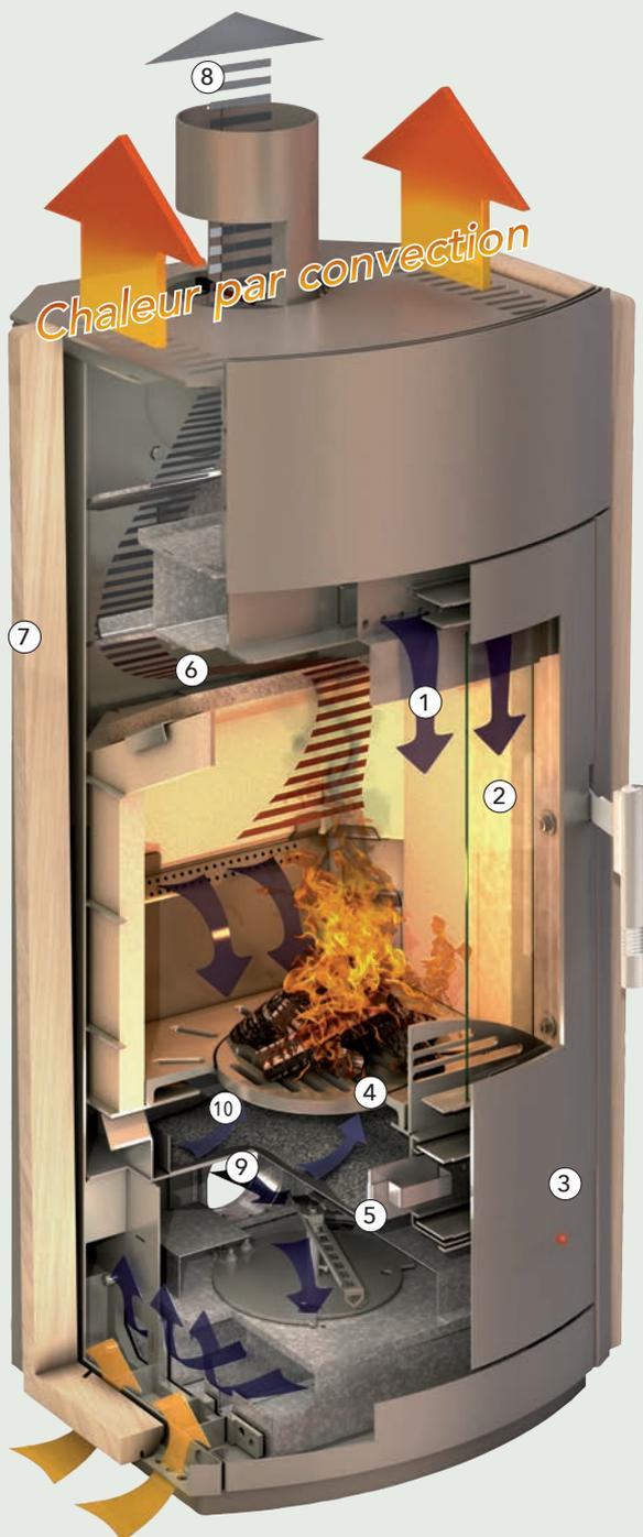
1. **Les vitres sont rincées en permanence** à l'air frais pour assurer la propreté et une vue dégagée sur les flammes.
